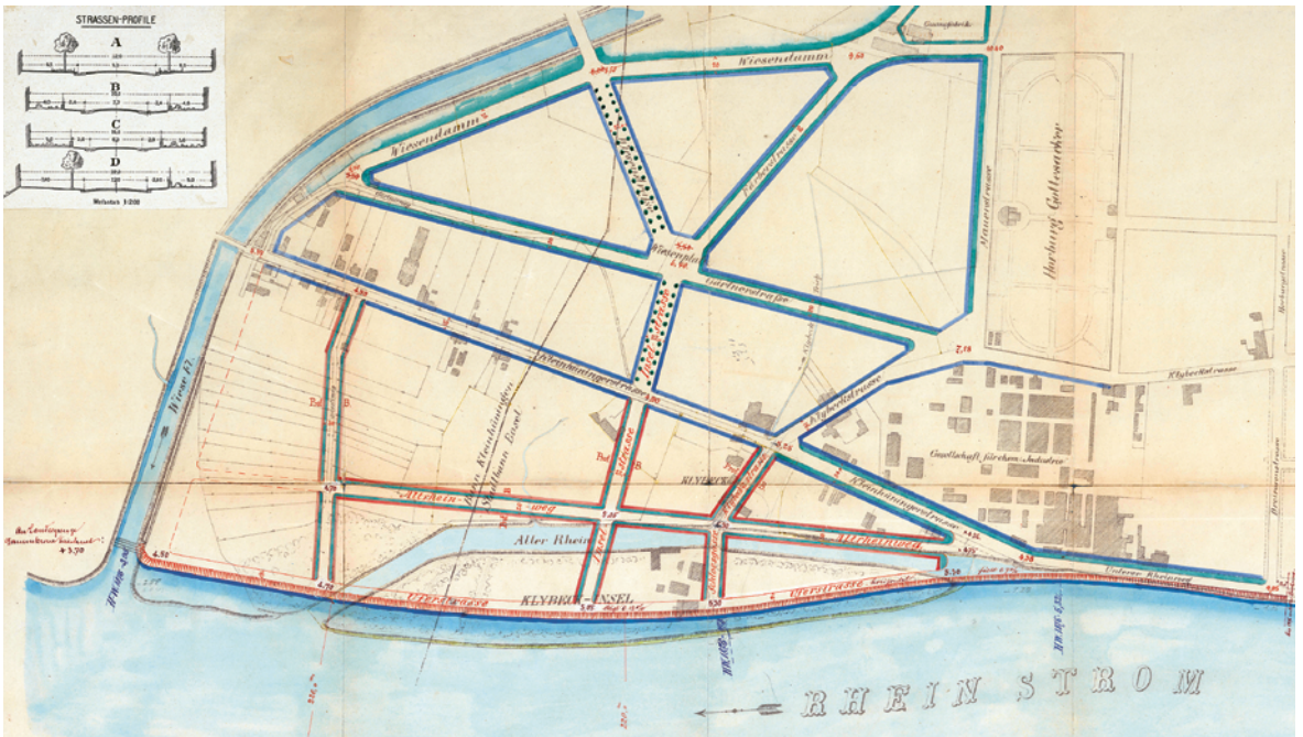
23 Strassenplanung im Klybeckareal: Übersichtsplan, Strassenprofile, Lichtpause von Hermann Bringolf, 1896. — Kantonsingenieur Hermann Bringolf zeichnete 1896 in Farbe das geplante Strassennetz über den älteren Situationsplan des Klybecks. Die historische
