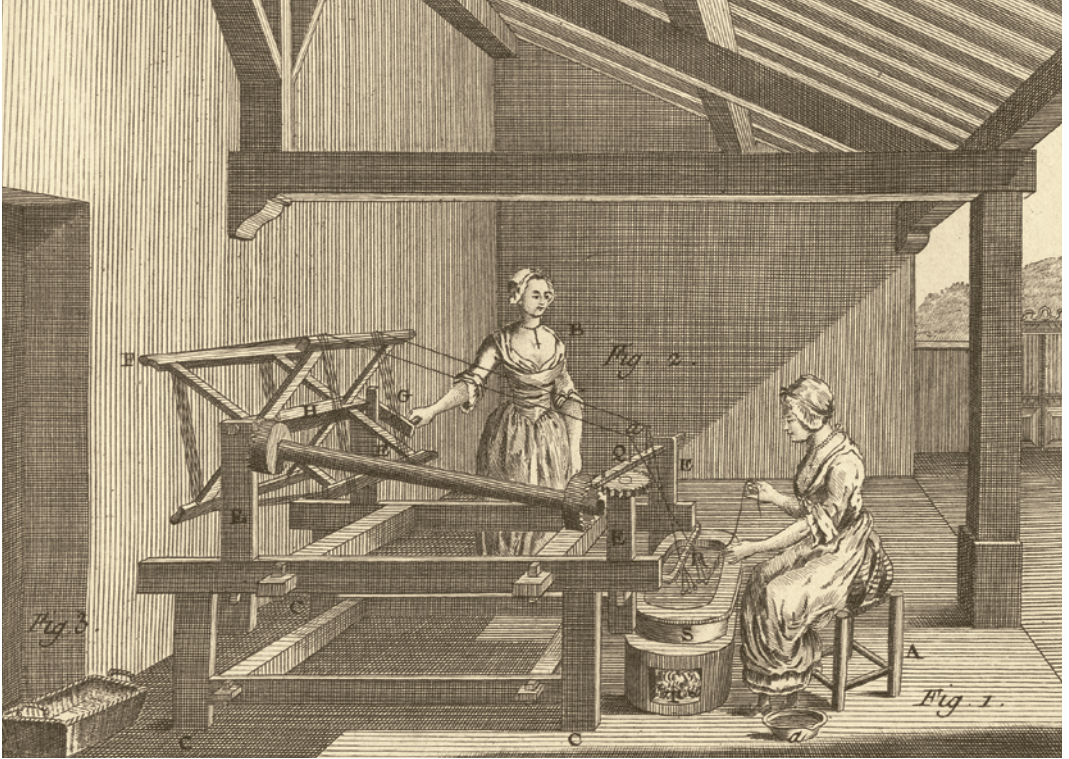
55 «Soierie, Tirage de la Soie et Plan du Tour de Piémont», Kupferstich aus der «Encyclopédie Méthodique» von Diderot und d’Alembert, 1786. — Diderots und d’Alemberts «Encyclopédie» war eines der Hauptwerke der Aufklärung. Sie sollte alles vorhandene Wissen sammeln und zugänglich machen. Das Bild zeigt die Herstellung von Rohseide vor der Industrialisierung der Produktion. Die Arbeiterinnen ziehen den Seidenfaden aus einem Bassin mit gekochten und aufgelösten Seidenkokons. Die Seidenfäden werden danach auf einer Haspel («Tour de Piémont») aufgespult, wie sie in den norditalienischen Zentren der Seidenproduktion im Gebrauch war.
