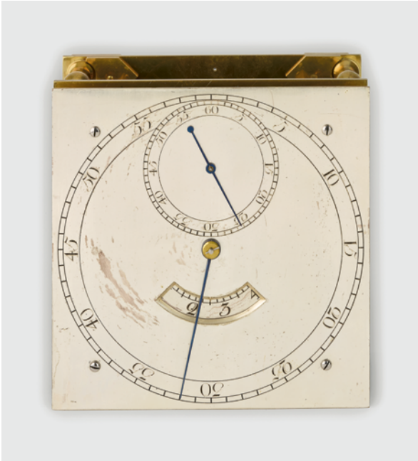
115 Chronometer, hergestellt von Thomas Mudge nach einem Entwurf von Johann Jakob Huber, 1755. — Huber und Mudge konstruierten erstmals eine Uhr mit konstantem Antrieb auf der Grundlage einer sogenannten freien Hemmung, die weniger Reibung aufwies und dadurch zuverlässiger als ältere Modelle funktionierte.
