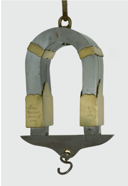
114 Johann Dietrich, «Diederichscher Magnet», 1755. — Daniel Bernoulli liess 1755 im Rahmen seiner Studien zum Magnetismus beim Basler Goldschmied Johann Dietrich (1715–1758) einen hufeisenförmigen Magneten anfertigen. Anhand des Objekts stellte er Beziehungen zwischen der Tragkraft eines Magneten, seiner Oberfläche und seinem Gewicht her.
