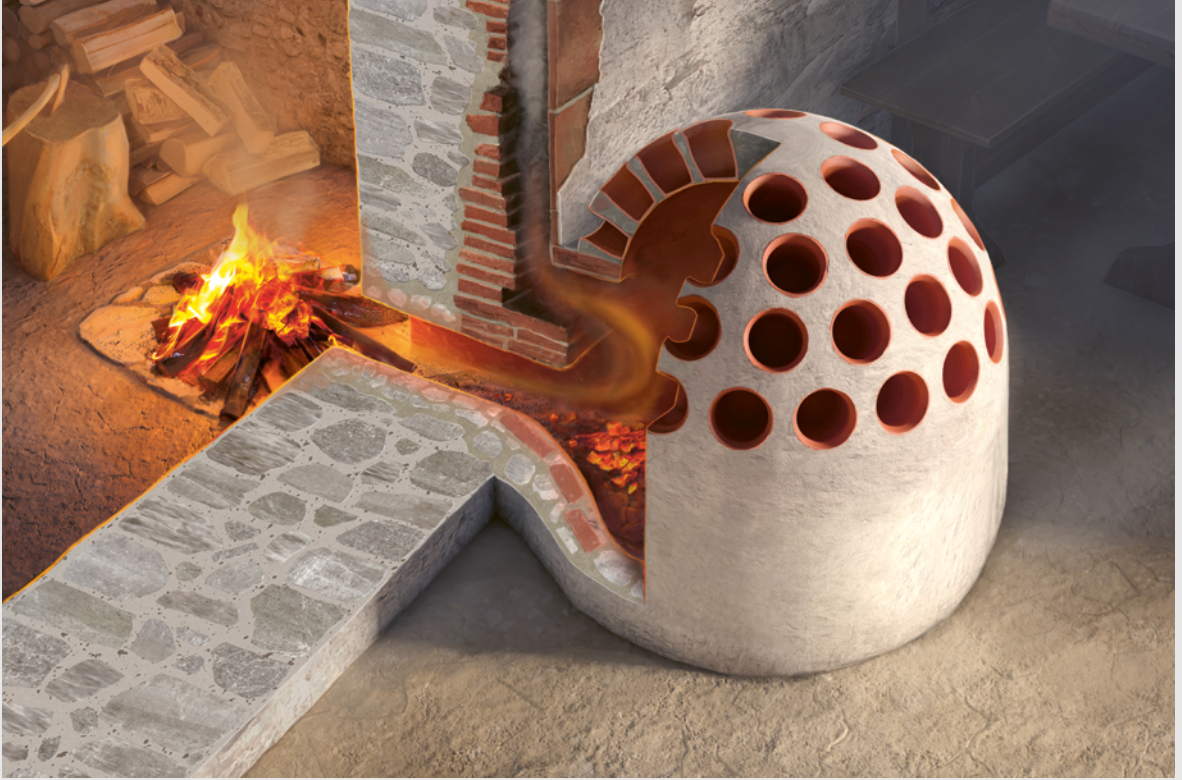
107 Rekonstruktion eines Kachelofens der Zeit um 950 aus Lausen-Bettenach.
