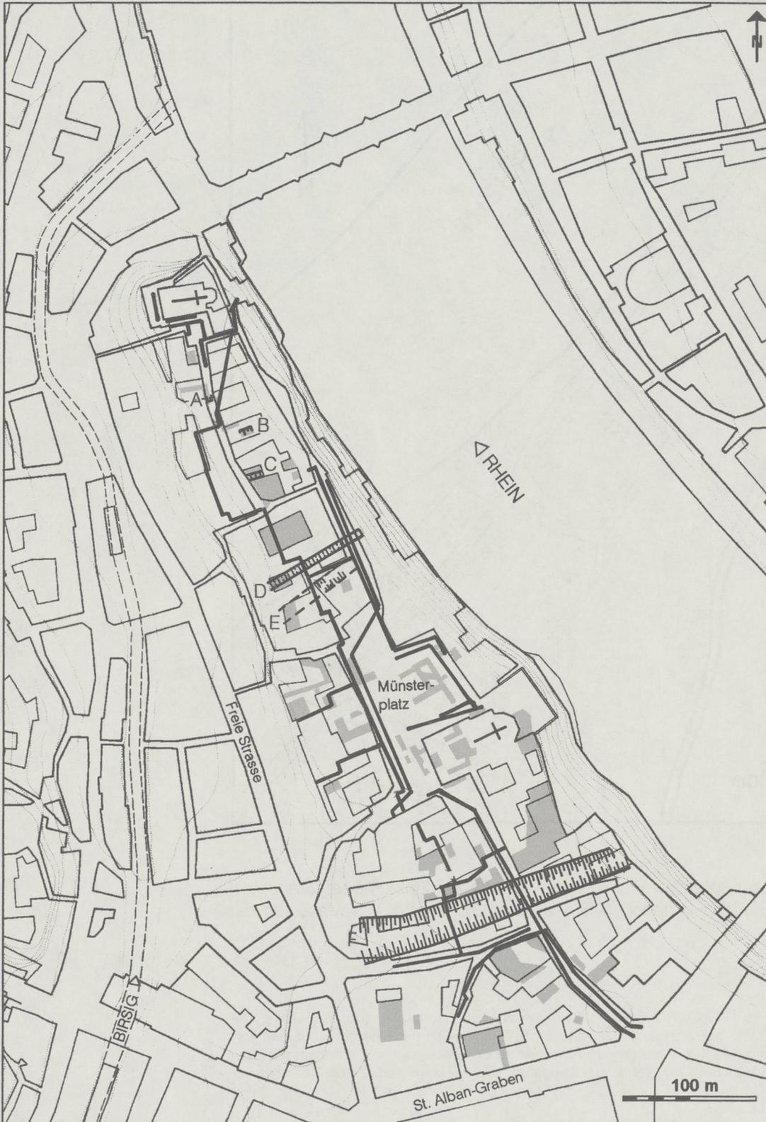
Abb. 2. Übersichtsplan der Werkleitungstrassen (fette Linien) und Grabungszonen (Rasterzonen) auf Basel-Münsterhügel. – Massstab 1:4000.
